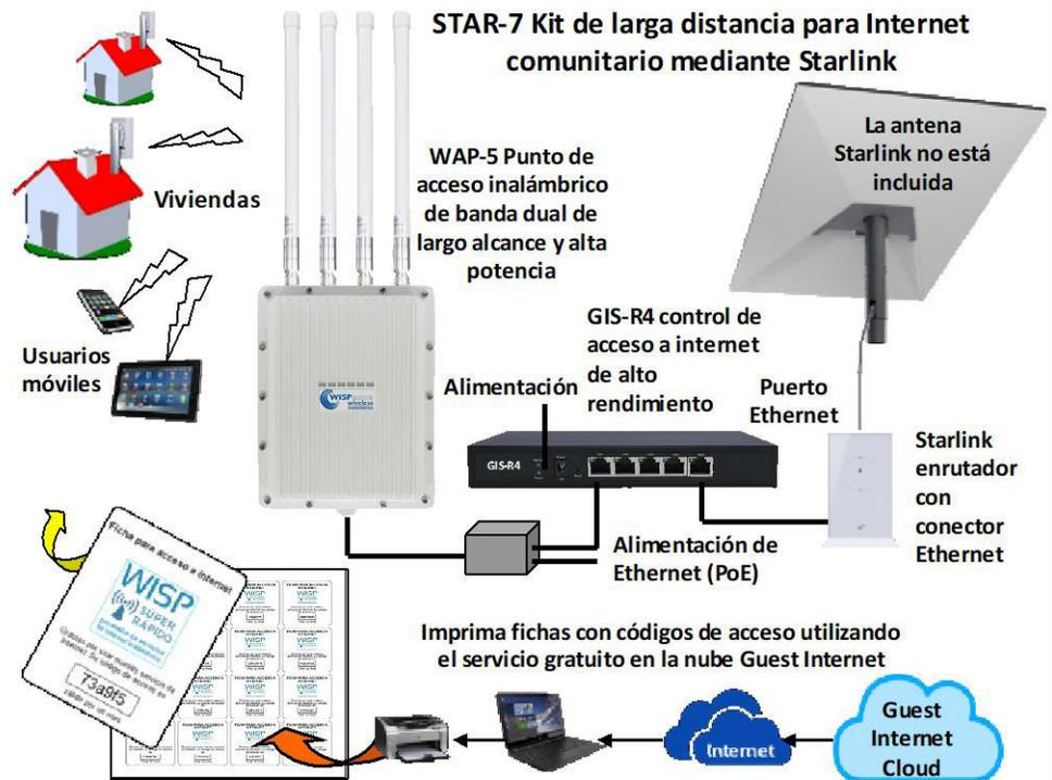
El instalador debe proporcionar el cable Ethernet que conecta el WAP-53 a la fuente PoE.
